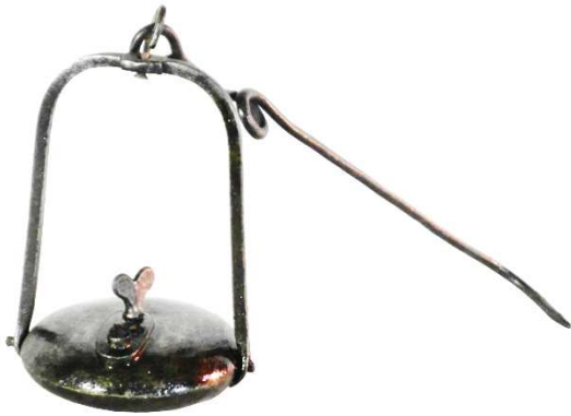
Modèle 110 mm ordinaire à bascule, la tête de la vis est en forme de cœur (coll. part.).
